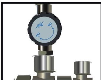
Les réglages d'air se font avec le détendeur au dessus du manomètre. Tirez, tournez pour faire varier la pression sur le mano puis appuyez.
